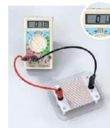
Fig. 3a :  $R_{\text{cuivre}} = 1,8 \Omega$
