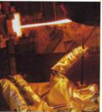
**3** Coule d'aluminium liquide. L'aluminium passe à l'état liquide à 660 °C.
