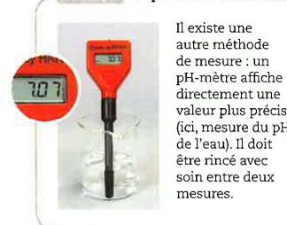
Il existe une autre méthode de mesure : un pH-mètre affiche directement une valeur plus précise (ici, mesure du pH de l'eau). Il doit être rincé avec soin entre deux mesures.
