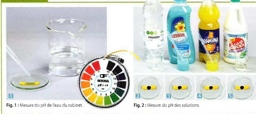
Fig. 1 : Mesure du pH de l'eau du robinet.
