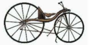
En 1861, les frères Pierre et Ernest Michaux, de Paris, ont créé un système de pédalage "rotatif", à l'origine du concept actuel. On a fixé deux manivelles et des pédales au moyeu de la roue avant. En pédalant, la rotation de la roue avant mettait le vélo en mouvement. Le "Vélocipède" était né.
