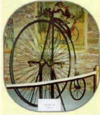
Puis le grand bi en bois fut remplacé par le grand bi en acier. Vers 1875, le français Jules Truffault allégea jantes et fourches en les fabriquant creuses à partir d'un stock déclassé de fourreaux de sabre et construisit une machine en remplaçant les lourds rayons en bois par des rayons métalliques en tension.
